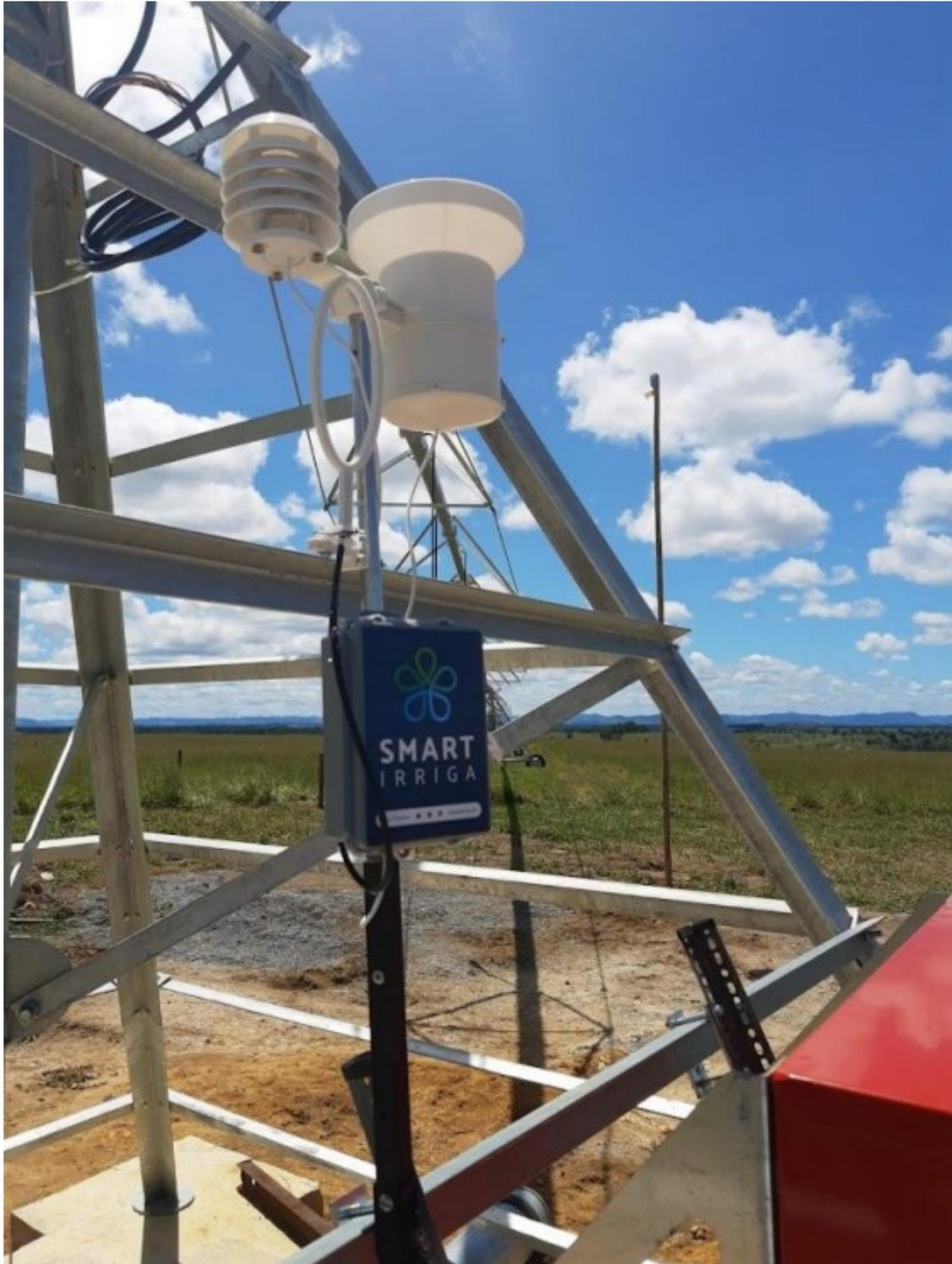
Fig. 06 – Estação climatológica para manejo de irrigação na 6ª Propriedade (Manejo de Irrigação em Pivô em Medeiros Neto/BA)
