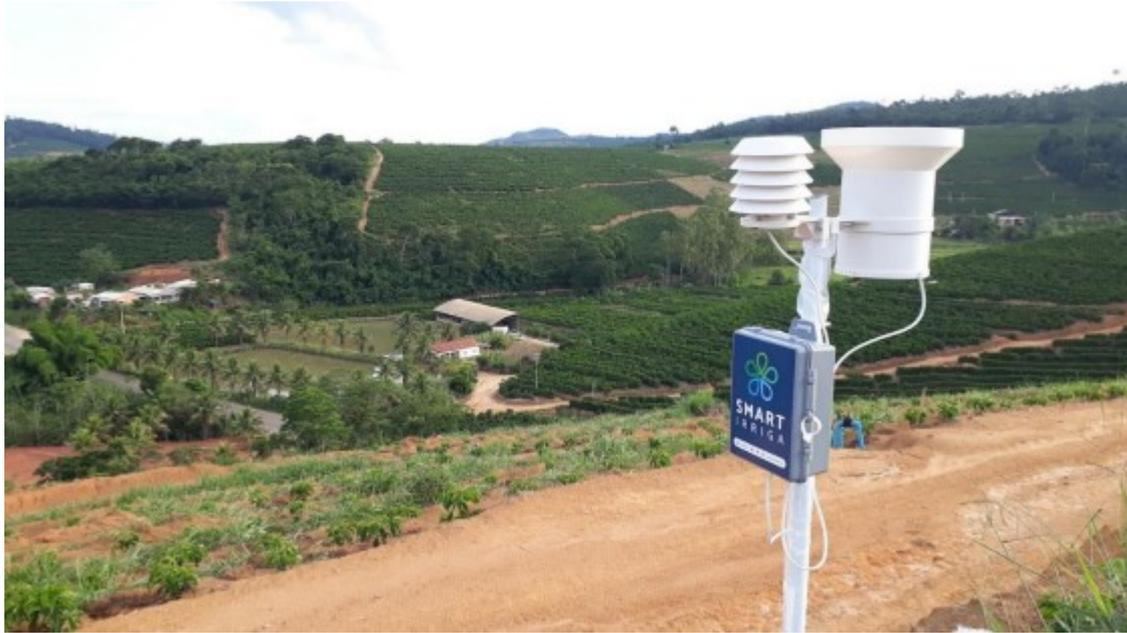
Fig. 03 – Estação climatológica para manejo de irrigação na 4ª Propriedade
