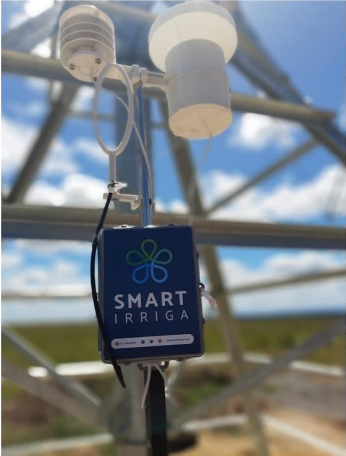
Fig. 05 – Estação climatológica para manejo de irrigação na 6ª Propriedade (Manejo de Irrigação em Pivô em Medeiros Neto/BA)
